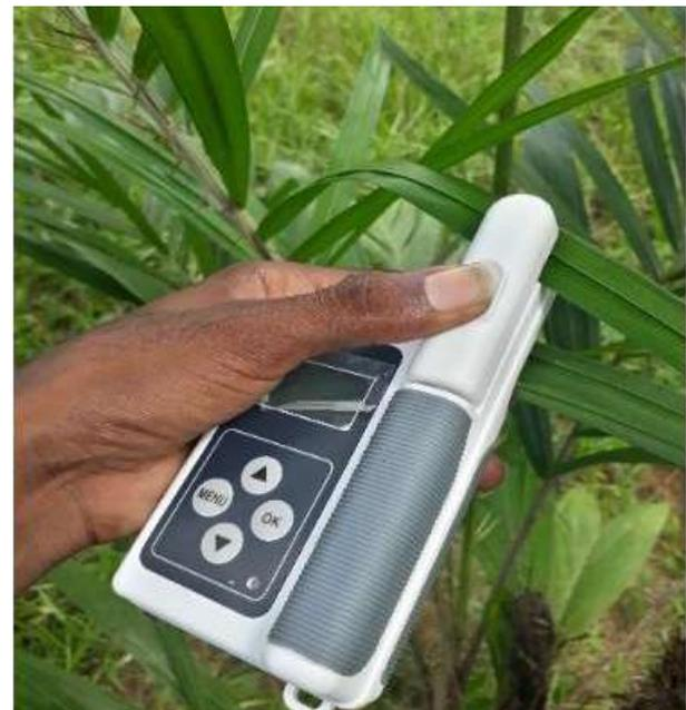
**Figura 6.** Obtención de valores de verdor de la hoja mediante el medidor de clorofila.
