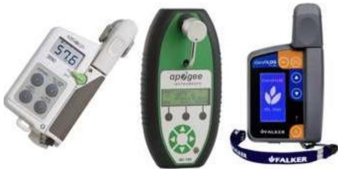
**Figura 4.** Diferentes modelos de Medidores de clorofila.
