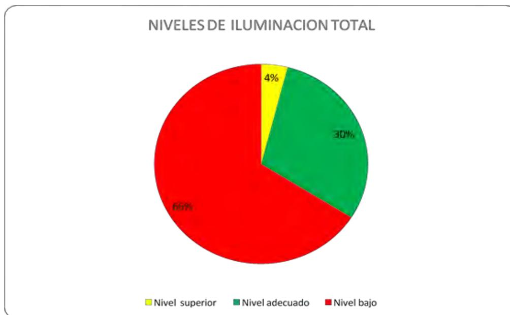
**Niveles de iluminación bajos:** 66 de los 100 puestos de trabajo evaluados presentan niveles de iluminación bajos según lo establecido por el reglamento técnico de iluminación y alumbrado público (RETILAP)
